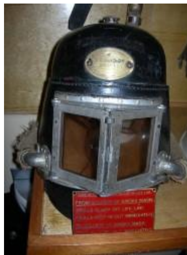
Дымовые шлемы Siebe Gorman. Кожаная маска крепилась к шлангу, который, в свою очередь, присоединялся к ножным мехам. Один пожарный надевал маску, в то время как второй обеспечивал подачу воздуха, накачивая его мехами. Сигналы подавались дерганием за шланг. 1 рывок означал «больше воздуха», 2 рывка — «меньше воздуха», 3 рывка — сигнал о помощи.
