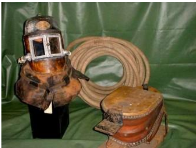
Дымовые шлемы Siebe Gorman. Кожаная маска крепилась к шлангу, который, в свою очередь, присоединялся к ножным мехам. Один пожарный надевал маску, в то время как второй обеспечивал подачу воздуха, накачивая его мехами. Сигналы подавались дерганием за шланг. 1 рывок означал «больше воздуха», 2 рывка — «меньше воздуха», 3 рывка — сигнал о помощи.
